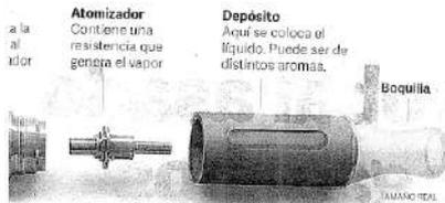
3 Al succionar por la boquilla, se aspira el vapor generado en el atomizador, más el aire que ingresa por un orificio del anillo.
