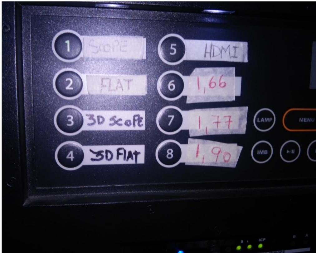
Proyector digital. Lateral. Detalle de botonera para seleccionar tipo de pantalla y dimensiones de proyecciones.
