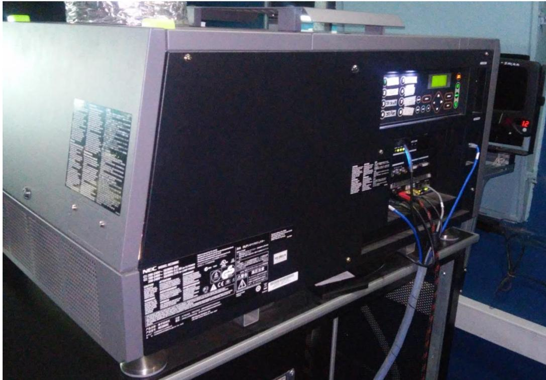
Proyector digital. Lateral. Botoneras, conexiones, e “ingesta” de disco duro
